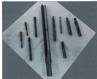
Typische Komet®-Werkzeuge, mit denen im Conti-Werk Gifhorn Komponenten von Bremsbetätigungssystemen bearbeitet werden. Nachschleifbare Werkzeuge werden von Komet-Service®-Partner Kanne instand gesetzt. (Fotos: Komet Group/Continental)
